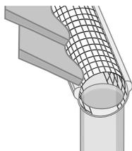
Die Öffnung zu einem Fallrohr aus dem Gitter heraus schneiden. Vorhandenes Sieb im Fallrohr entfernen.
