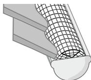
Um zu verhindern, dass Vögel im Rohr nisten, die Enden wie folgt schließen: Gitter an den Enden einschneiden und das Material nach unten klappen.
