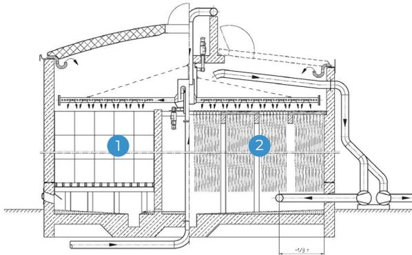
1. Position von BIO-NET® in einer Tropfkörperanlage.
