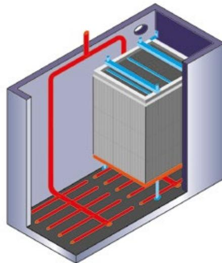
Eine Festbetteinheit in Käfigausführung mit integrierter Belüftung. Die Einheit kann mit einem Kran aus dem Becken gehoben werden.
