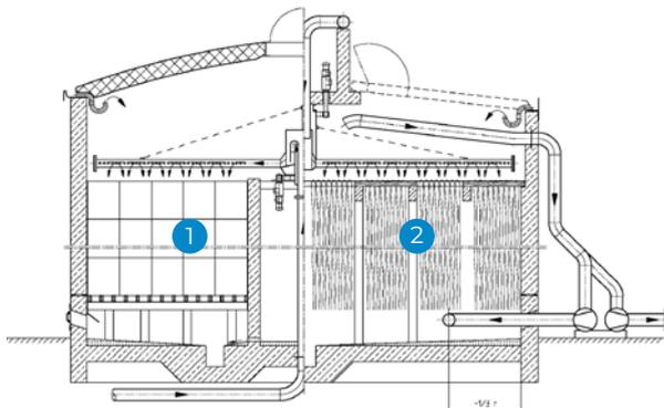
1. Position von BIO-NET in einer Tropfkörperanlage.
